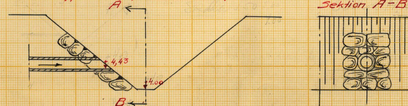
Typritning för ommurning vid 61+85. Skala 1:50.
